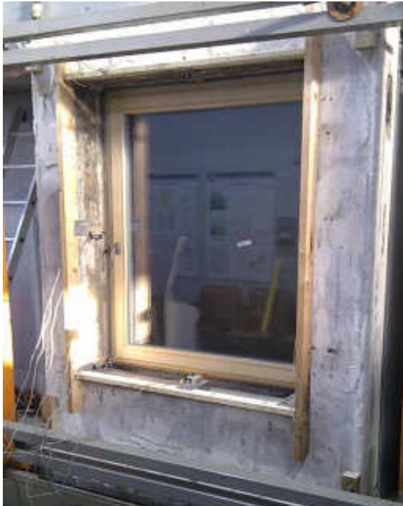
Bild 1 Probekörperansicht von der Raumseite mit angebrachten Verformungsaufnehmern
